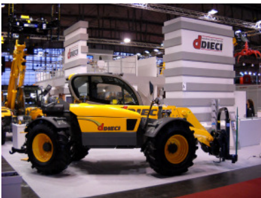
Bild 2 - Der italienische Teleskoplader-Hersteller „DIECI“ setzt ebenfalls auf ICVD-Technik von SAUER BIBUS und präsentierte Fahrzeuge mit dieser Antriebstechnik unter seinem Label „VS“, das für „Vario System“ steht.
